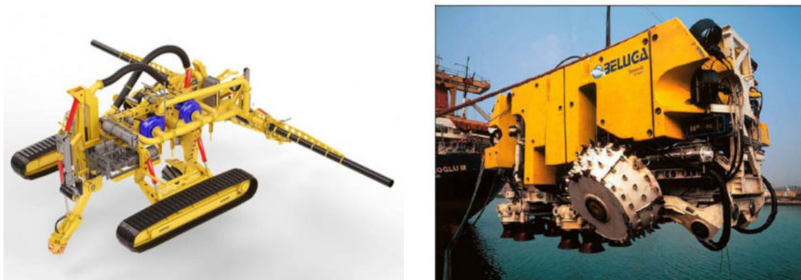
Figura 9.4: Esempio di Mezzo Sottomarino Tradizionale per Operazione di Interramento della Condotta con Post Trenching
